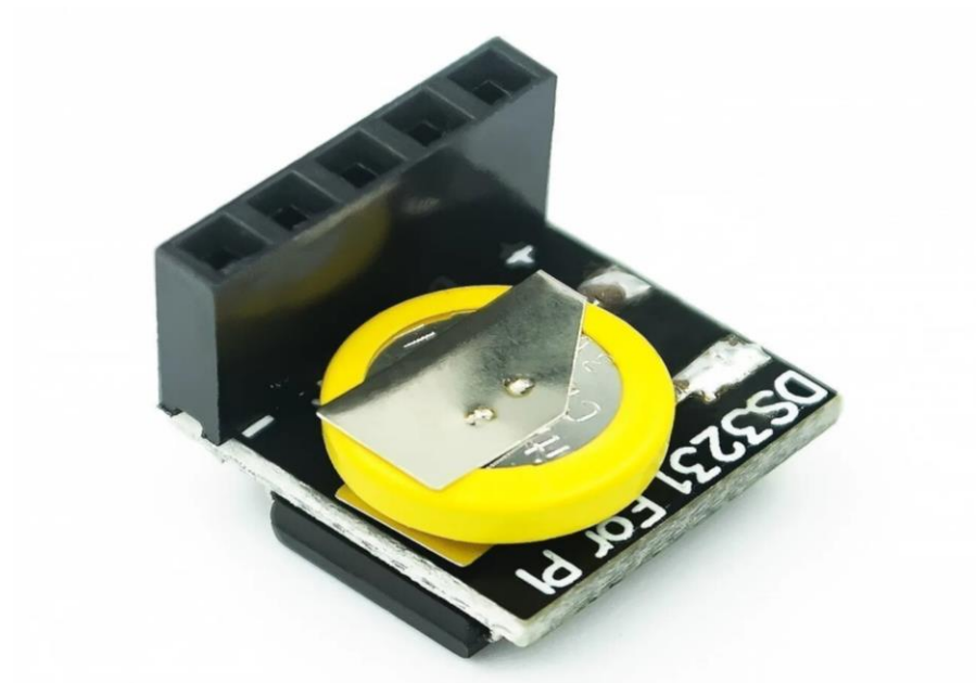
RTC-модуль DS3231 — часы реального времени с резервным источником питания для стабильной работы по расписанию
