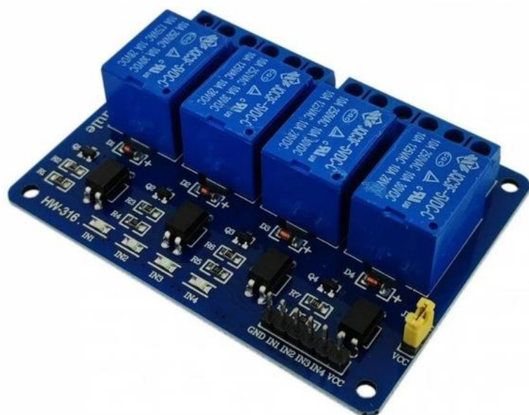
4-канальный релейный модуль 5В 10А/250В
